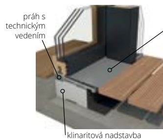
SKLOLAMINÁTOVÝ PRÁH s tepelně izolačními vložkami s 5 mm pojezdovou lištou a s vyrovnávací deskou prahu, která umožňuje téměř dokonalé vyrovnání terénu uvnitř i vně domu, šířka prahu 240 mm výška 42 mm
