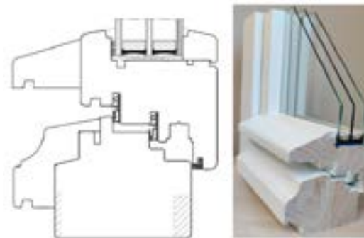
verze 4: k dispozici jsou okapové lišty v systému Energy Concept 90 Třída nepropustnosti vody – 5A (200 Pa)
