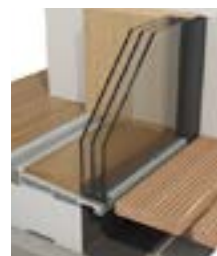
SKLOLAMINÁTOVÝ PRÁH s tepelně izolačními vložkami s 5 mm pojezdovou lištou a s vyrovnávací deskou prahu, která umožňuje téměř dokonalé vyrovnání terénu uvnitř i vně domu, šířka prahu 240 mm výška 42 mm
